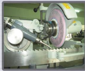
Быстрая заточка ленточных пил шириной до 100 мм
